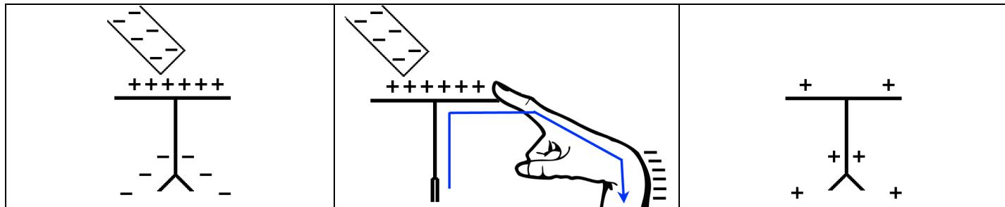
① Les électrons libres du plateau de l'électroscope sont repoussés par la charge (-) de l'ébonite. Ils vont le plus loin possible, c'est-à-dire à l'autre extrémité du dispositif, ce qui écarte l'aiguille mobile et indique la présence de charges (elles sont donc négatives).
